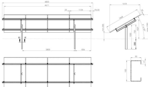
**DETALHES DA ESTRUTURA E FUNDAÇÃO**
